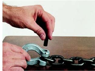
1. Placer le maillon de la chaîne dans la chape ou coupleur de chaîne. Insérez la goupille totalement dans les oreilles de la chape.
