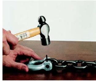
2. Placer le maillon du coupleur sur son côté et, en utilisant un marteau, enfoncez la goupille de verrouillage dans l'oreille de la chape jusqu'à ce qu'elle soit encastrée dans la surface extérieure.
