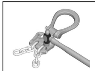
2. Placer l'Eliminator sur une surface stable. Avec un marteau, tapez sur la goupille de verrouillage dans la chape à deux brins jusqu'à ce qu'elle soit entièrement encastrée.
