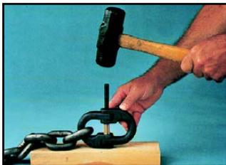
2. Faites pénétrer la goupille dans l'extrémité de la maille assemblée et du manchon jusqu'à ce que l'extrémité de la goupille soit encastrée dans l'extérieur des demi-maillons de raccordement.
