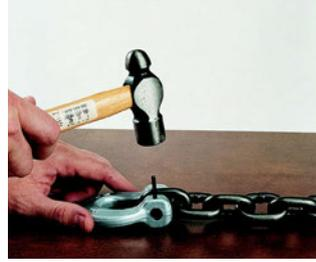
2. Die Koppelverbindung auf die Seite legen und mit einem Hammer den Sperrbolzen in das Gabelohr schlagen, bis er mit der Außenfläche eben ist.
