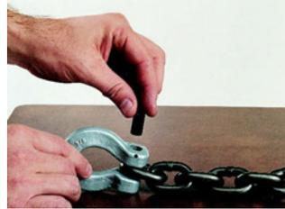
1. Kettenglied in Gabel der Kettenkopplung einsetzen. Den Bolzen vollständig in die Gabelohren einsetzen.
