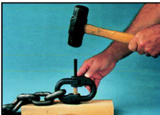
2. Den Bolzen durch die angefügten Verbindungsenden und die Hülse schieben, bis der Bolzen den Außenbereich der Verbindungshälften erreicht.
