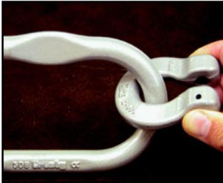
2. Die Koppelverbindung so drehen, dass der Bügel in Außenrichtung des Aufhängeglieds gerichtet ist und diesen mit Kettenanschlag verbinden.
