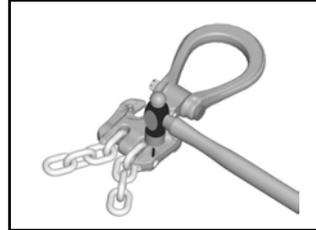
2. Die Eliminator®-Baugruppe auf einer festen Oberfläche positionieren. Den Sperrbolzen mit einem Hammer in die Doppelstranggabel schlagen, bis er die Bohrung vollständig ausfüllt.
